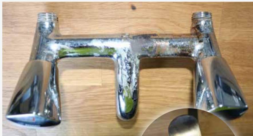
▲ Diese Wandbatterie wurde durch zu aggressivem Entkalkungsmittel beschädigt.
